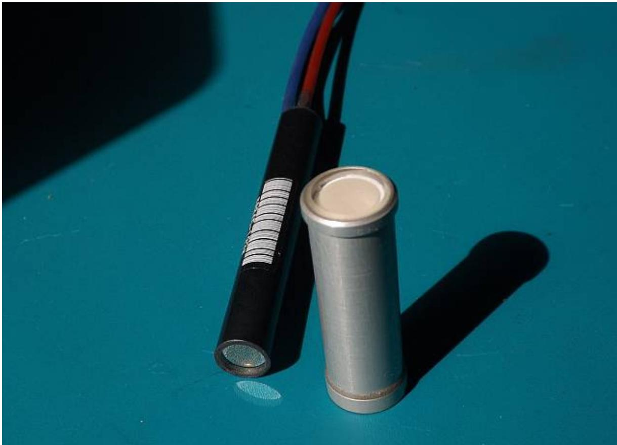
Abb. 1: 10x40mm NaI-Kristall und CPM von Perkin-Elmer
