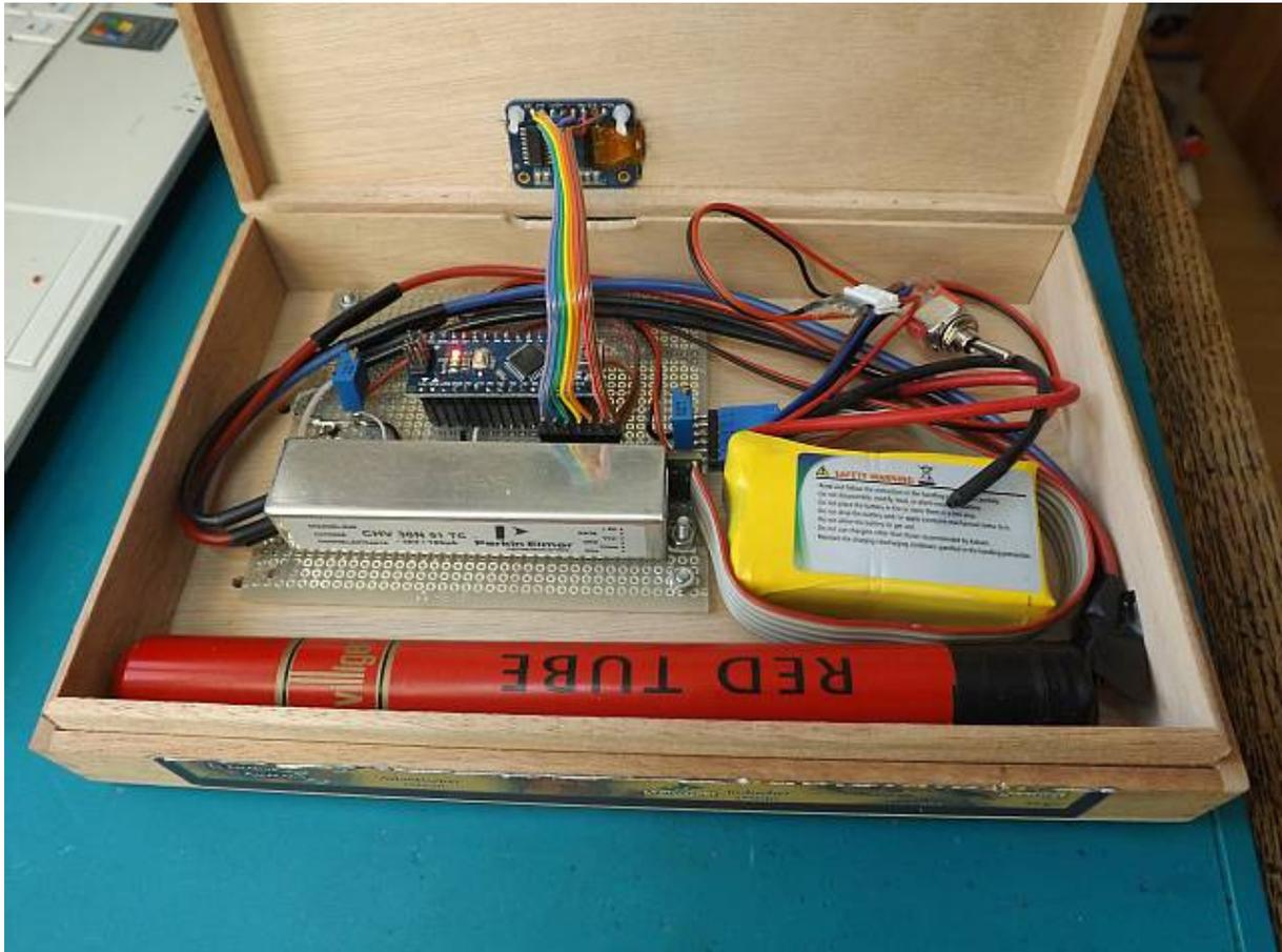
Abb. 5: Holzkiste als Prototypengehäuse, hinter dem Detektor-Rohr links das Hochspannungsmodul und der Arduino Nano, rechts der 3S1P-Flugmodell Akku (11.1V 910mAh)
