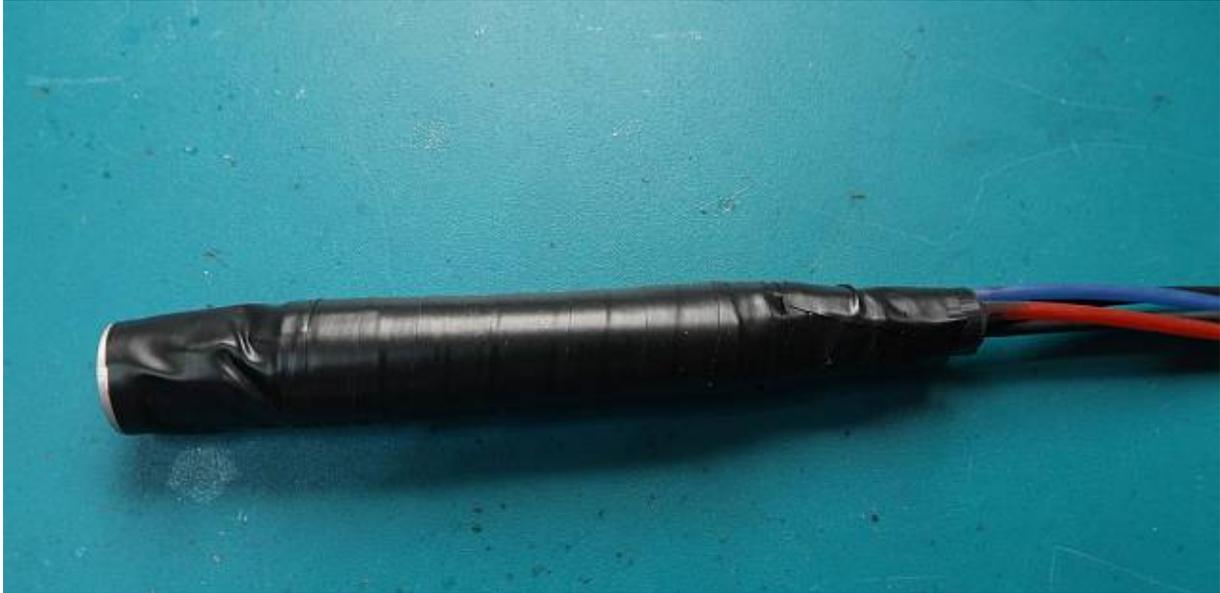
Abb. 2: Auf das CPM lichtdicht aufgesetzter Kristall
