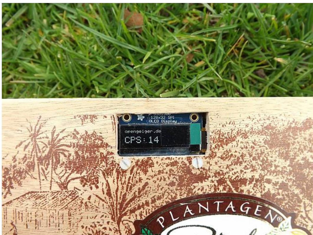
Abb. 7: OLED-Display Pixel mit hoher Leuchtkraft zeigen auch kleinste Zeichen gut lesbar an. Messung auf der Wiese im Schlossgarten (laut Gamma-ODL-Station ca. 0.12uSv/h in 1m Höhe)
