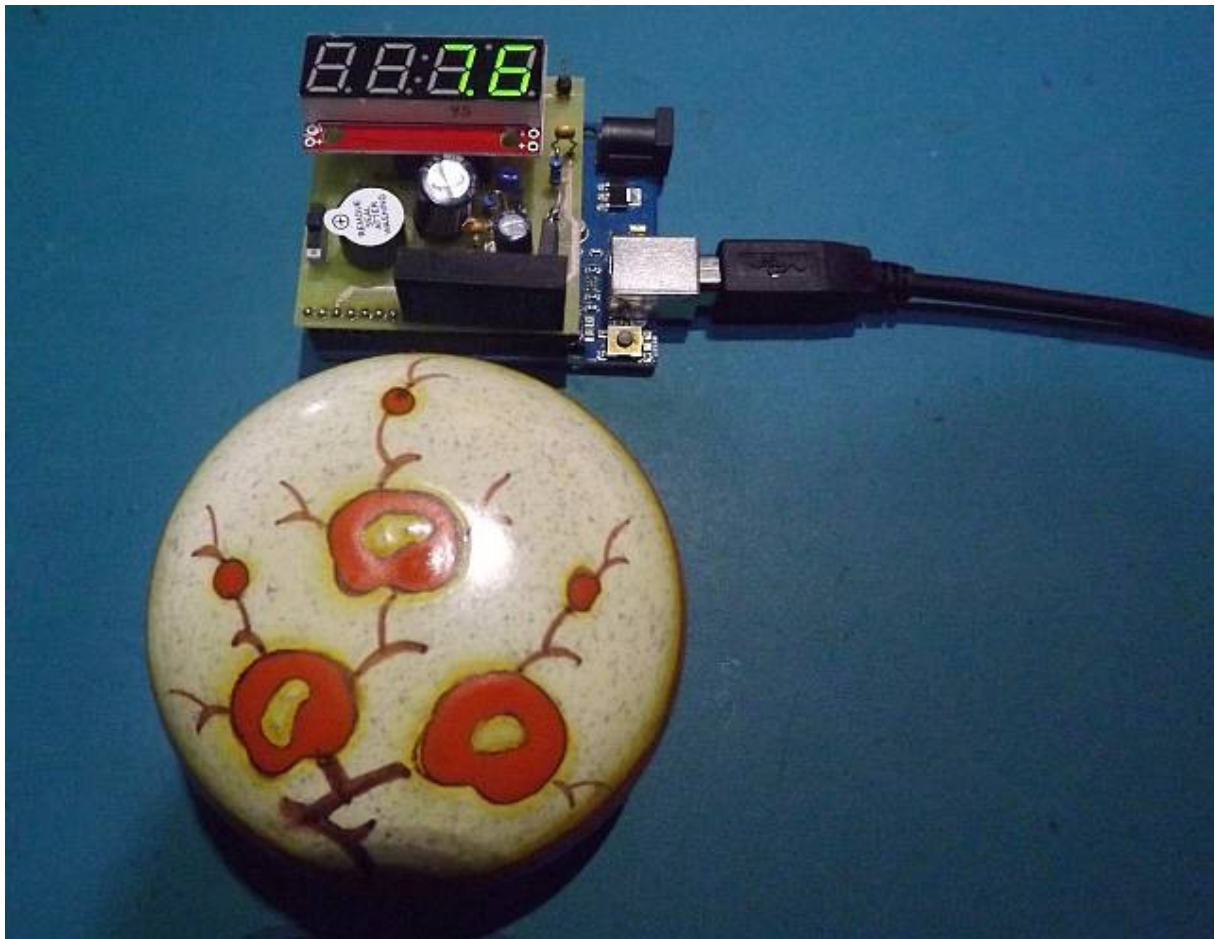
Abb. 3: Messung der Dosisleistung einer Uranglasur auf einer Keramikdose (der Piezo-Schallgeber ist noch mit einer Schutzfolie abgedeckt)
