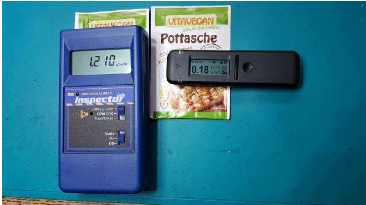
Abb. 17: Vergleichende Messung mit dem Radiacode-101 und dem Inspector an einem Päckchen Pottasche
