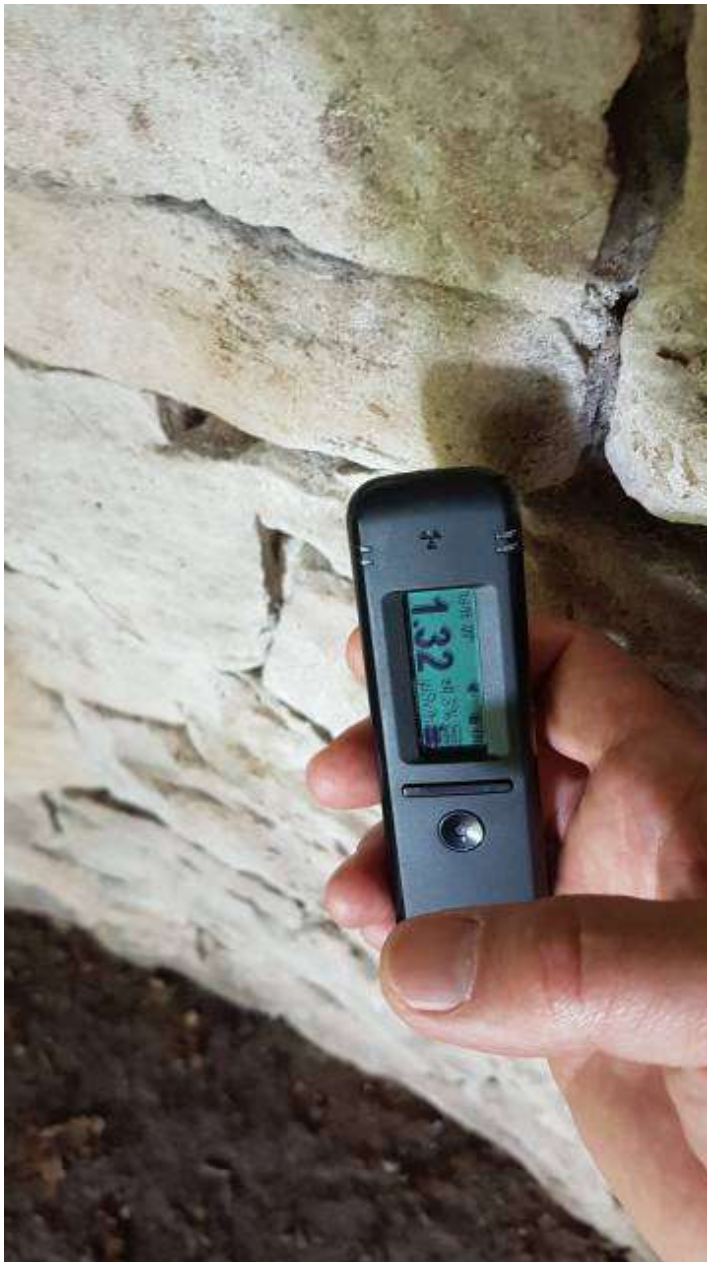
Abb. 12: Direkte Messung der Ortsdosisleistung in der Kapelle im Monitor-Modus des Geräts
