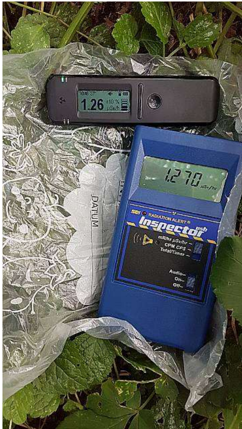
Abb. 16: Vergleichende Messung des RC101 und dem Inspector an einem Radiobaryt Hotspot am Silvertbach in Marl
