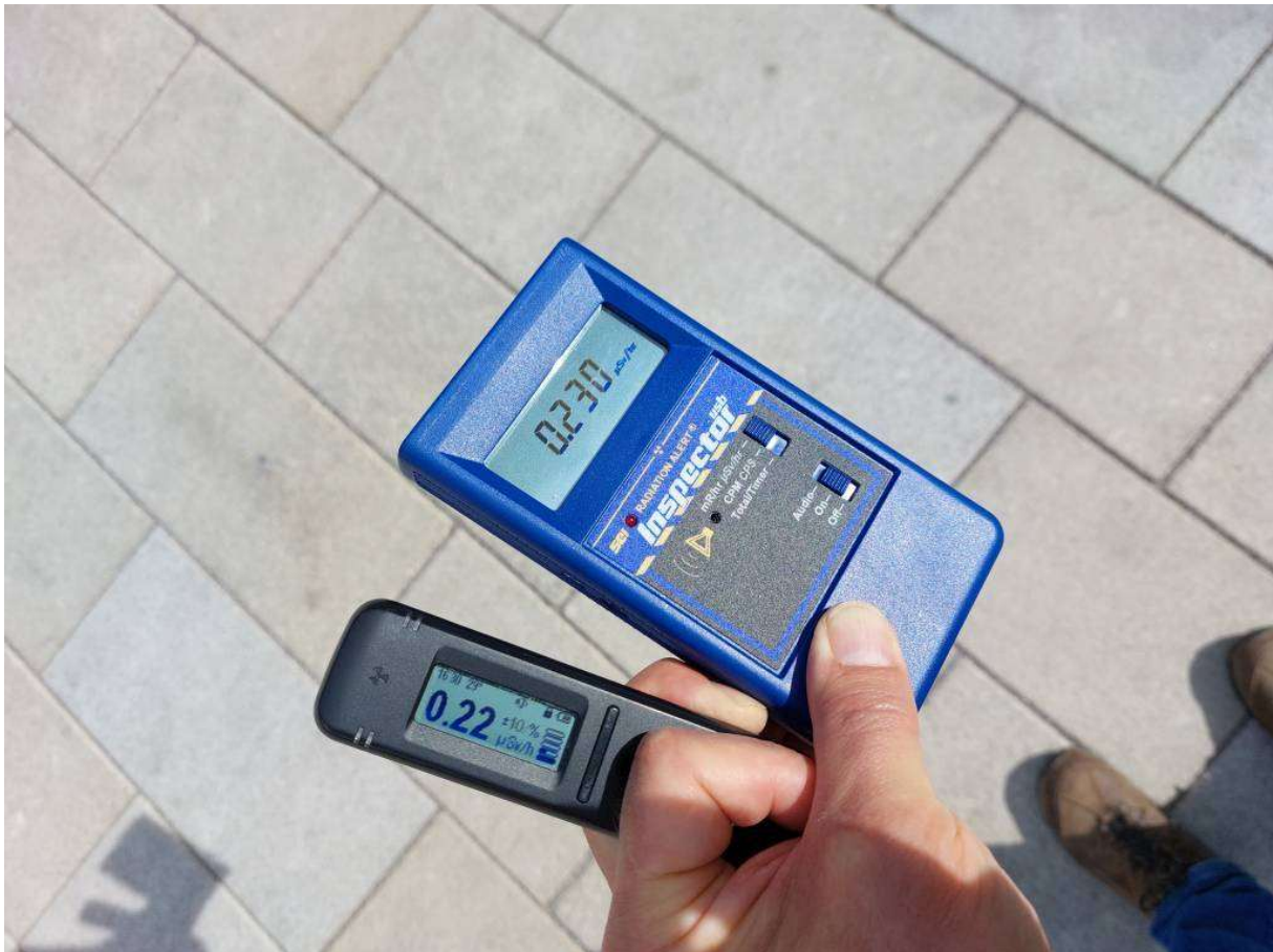
Abb. 6: Messung der Gamma-Ortsdosisleistung über dem Hauzenberger Granit auf dem sanierten Marktplatz
