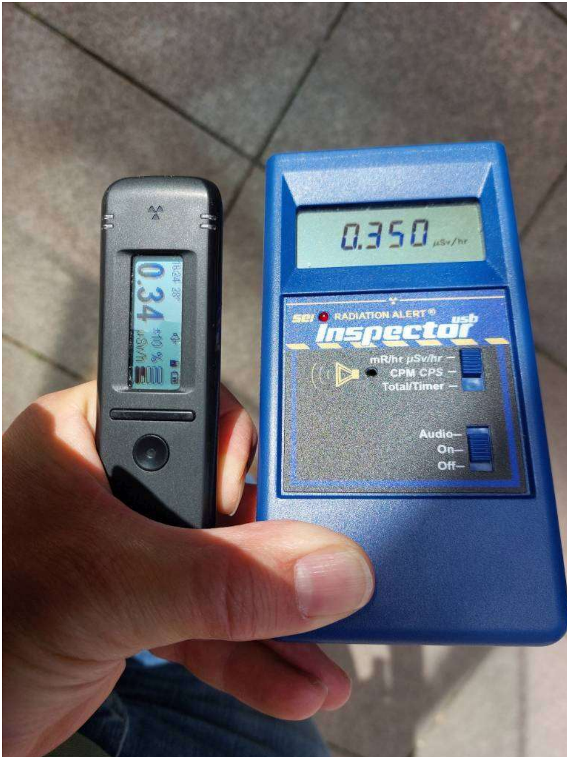
Abb. 8: Messung der Gamma-Ortsdosisleistung über dem Flossenbürger Granit auf der Stuttgarter Königstraße
