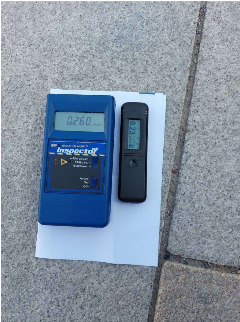
Abb. 5: Messung der Dosisleistung im Kontakt zum Hauzenberger Granit auf dem sanierten Marktplatz
