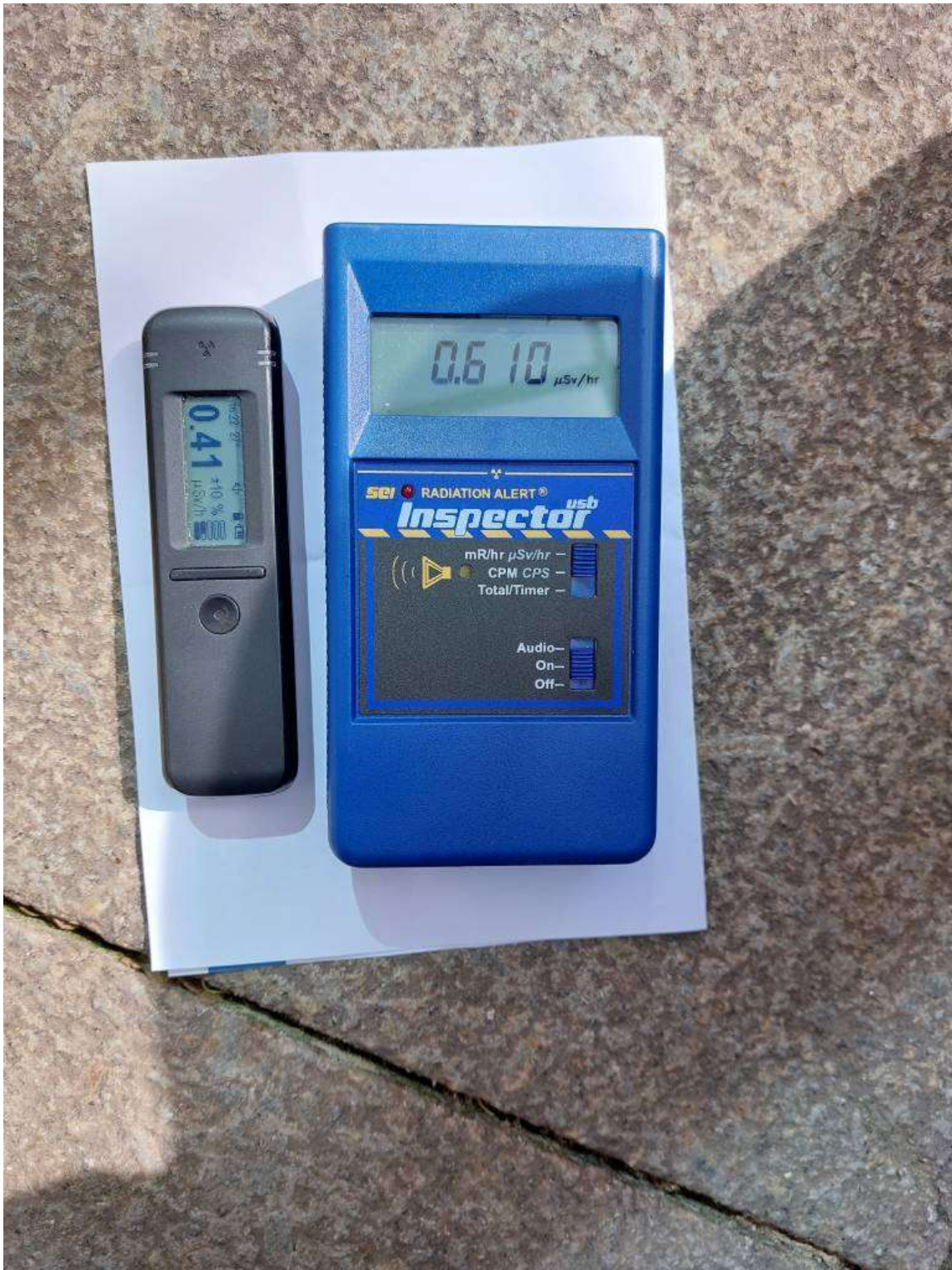
Abb. 7: Messung der Dosisleistung im Kontakt zum Flossenbürger Granit auf der Stuttgarter Königstraße
