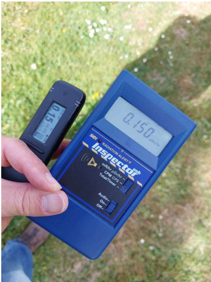
Abb. 10: Messung der Gamma-Ortsdosisleistung 1m über dem grasbepflanzten Boden des Stuttgarter Schlossgartens
