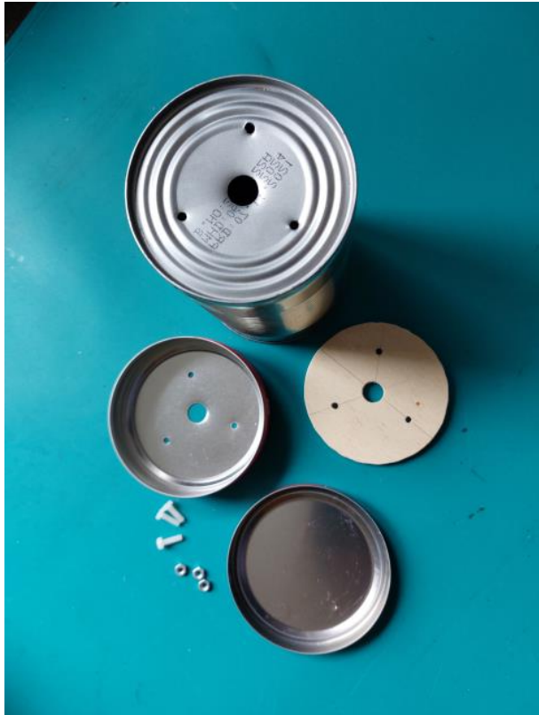
Abb. 4a, b: mechanische Bauteile und Kunststoffschrauben zum Verschrauben der Dosen
