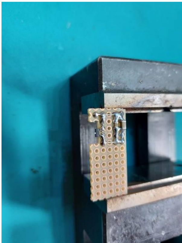
Abb. 7a, b: Lötén der JFET-Platine und Einfädeln des Kammerdrahts
