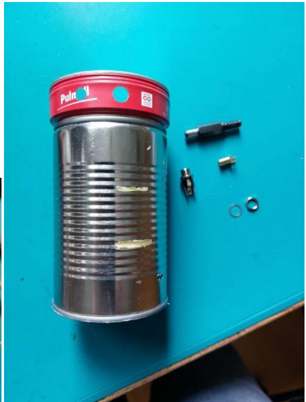
Abb. 6a, b: Oberes halbiertes Teflonband und Bohren der Löcher für die Buchsen
