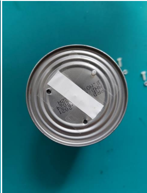
Abb. 4a, b: mechanische Bauteile und Kunststoffschrauben zum Verschrauben der Dosen
