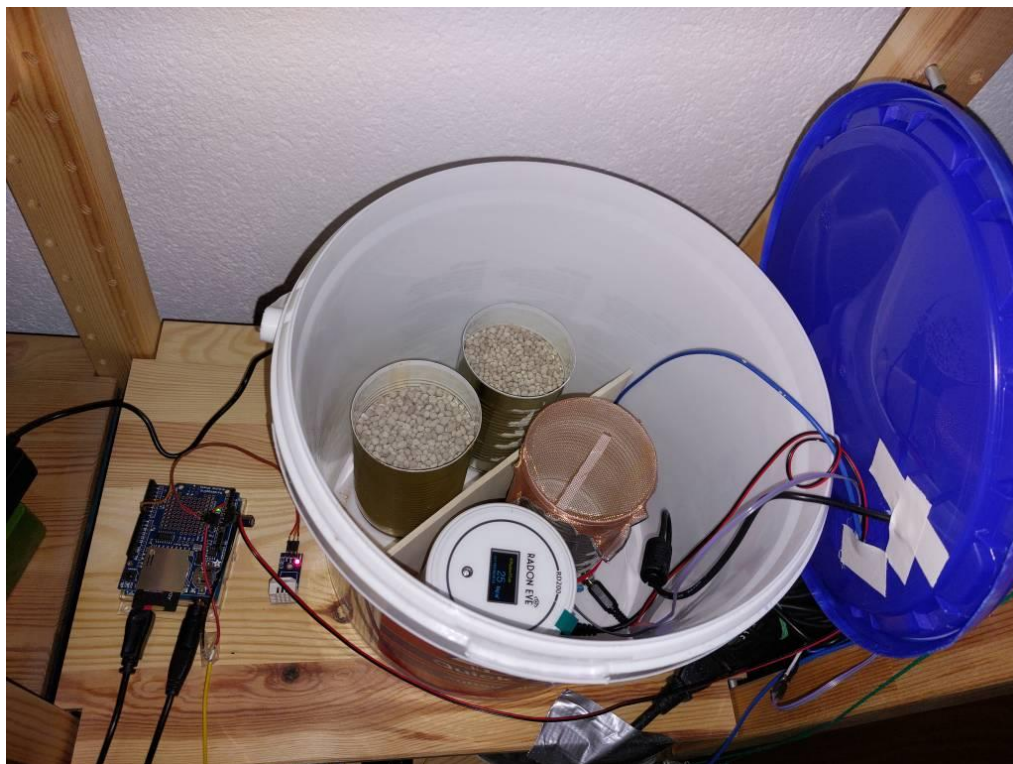
Abb. 16: Eimer mit Rikamlno BreakOut und RadonEye-Messgerät, als Radon-Quelle wurden hier 750g Superphosphat 18% (ICL Fertilizers) verteilt auf zwei Konservenbüchsen verwendet.
