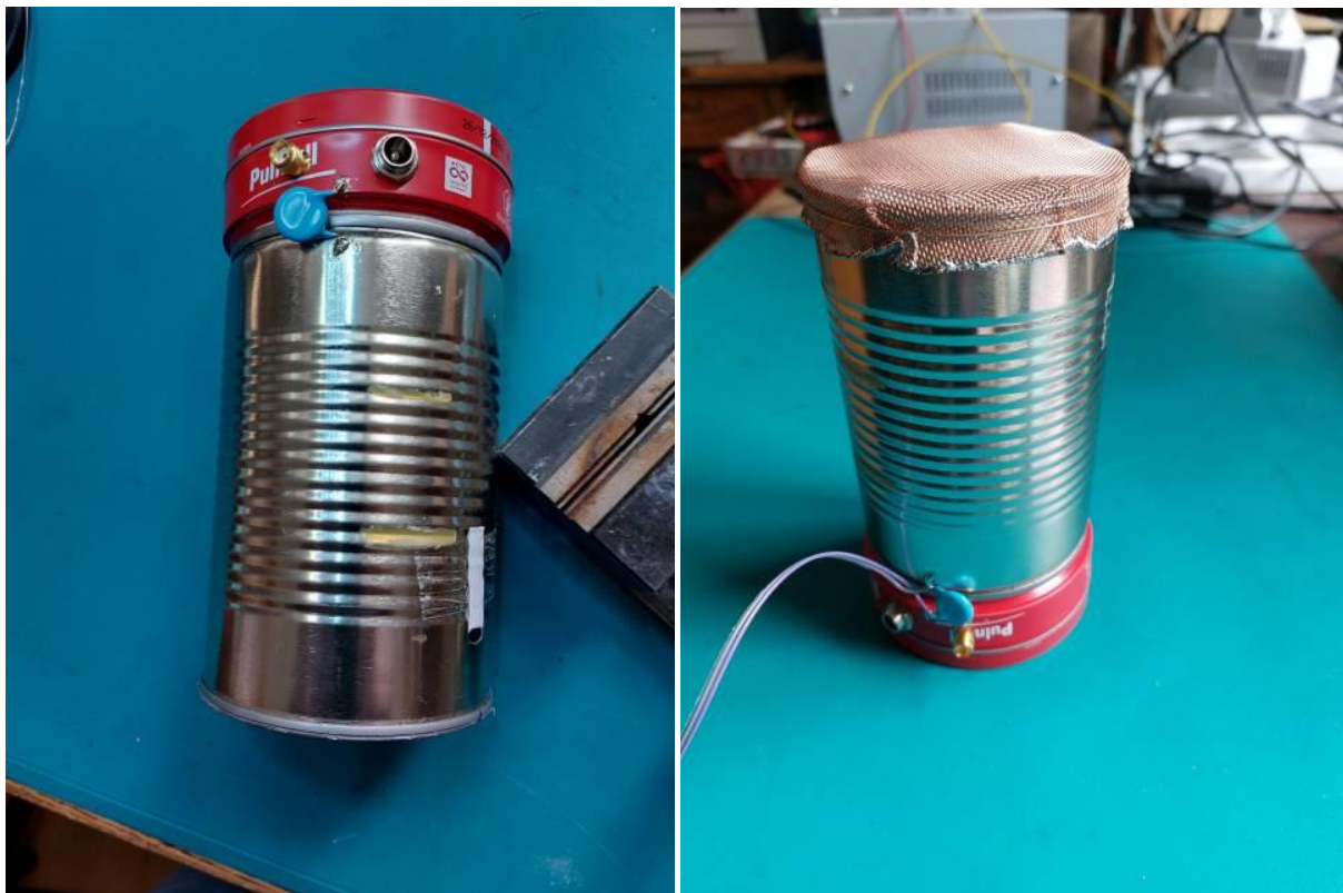
Abb. 9a, b: Koppelkapazität zwischen den Dosen und Abschirmgitter
