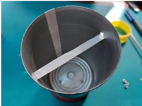
Abb. 6a, b: Oberes halbiertes Teflonband und Bohren der Löcher für die Buchsen
