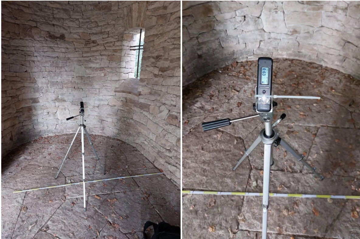
Bild 2a, b: Positionierung des Radiacode-101 im Referenzpunkt und angezeigte Gamma-Ortsdosisleistung
