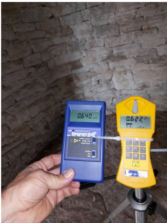
Bild 4: Täuschende Displayanzeige der Zählrohr-Messgeräte
