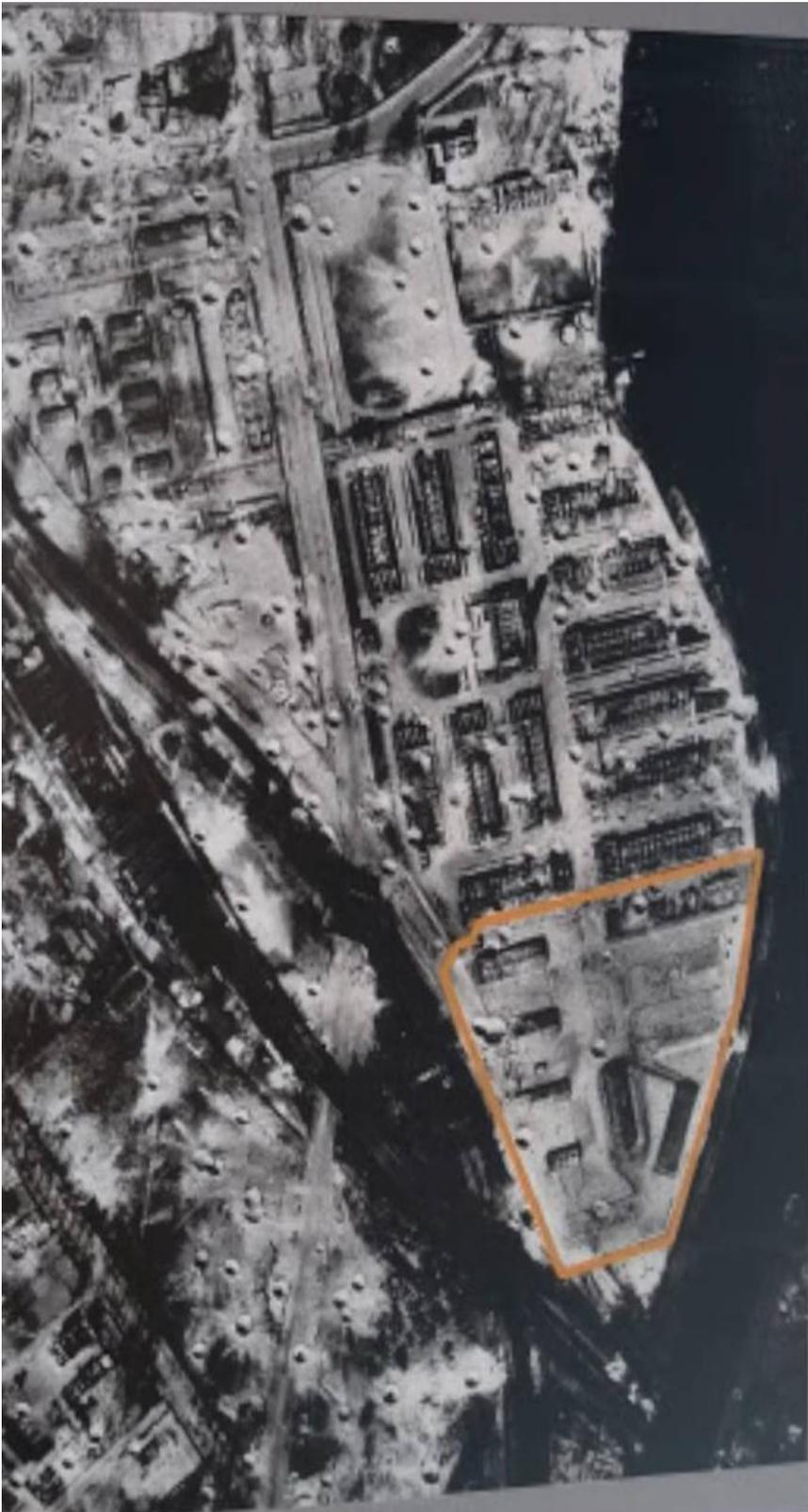
Abb. 5: Typischer „Bomb Plot“, der die zerstörten Gebäude nach dem Bombenangriff zeigt, es sind aber auch zahlreiche Bombenkrater zu sehen, die beim Wiederaufbau mit Thorium-haltigem Schutt verfüllt wurden
