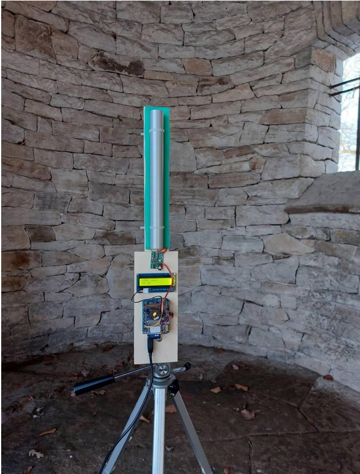
Abb. 6: Messung der  $H^*(10)$  Gamma-Ortsdosisleistung in der Kapelle im Höhenpark Killesberg mit der OM01-Sonde
