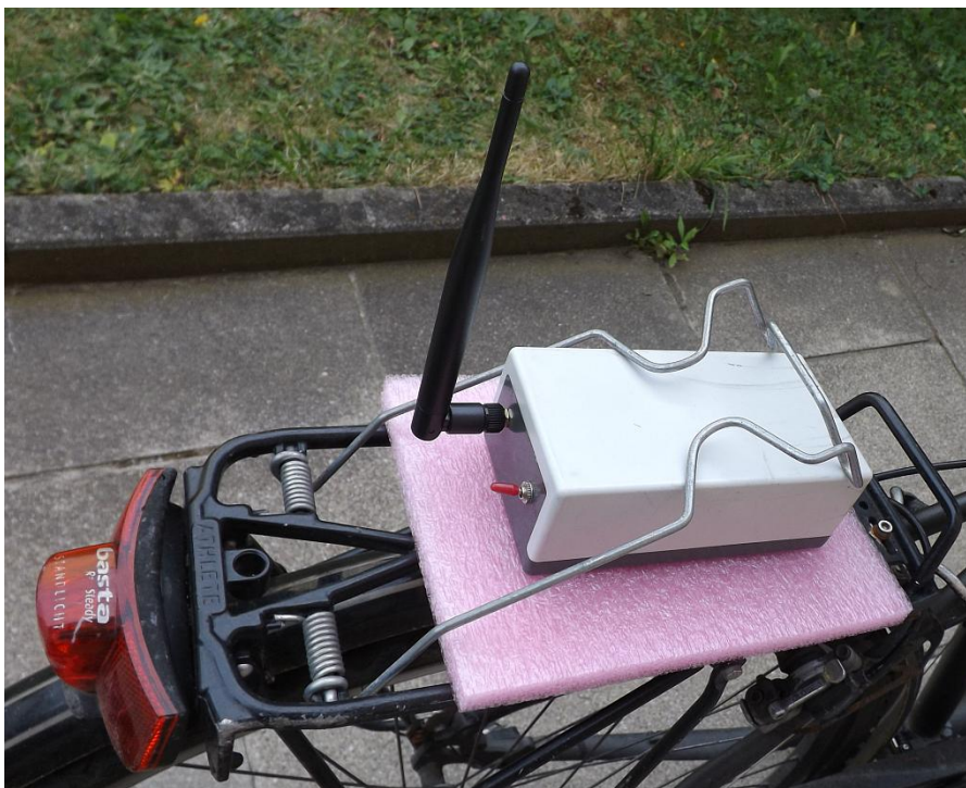
Abb. 1: LoRaWAN TTN-Mapper Gerät auf dem Fahrrad-Gepäckträger
