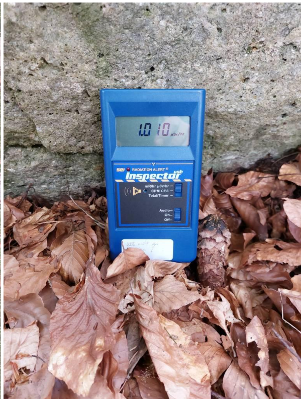
Abb. 14 und 15: Messungen am großen Kieselsandstein-Brocken mit dem Inspector
