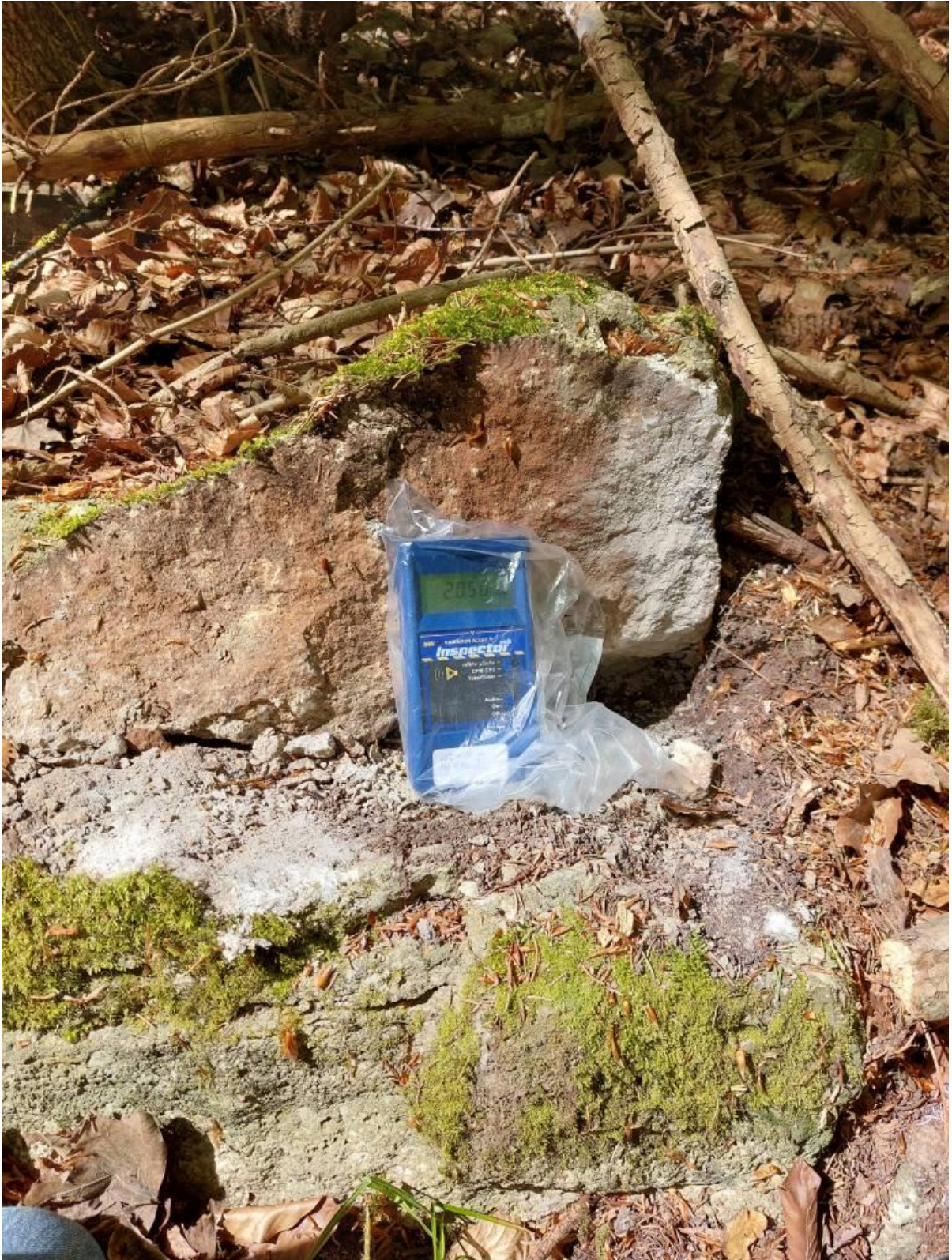
Abb. 16: Gespaltener Fleins-Brocken am Boden gemessen mit dem Inspector. Das Messgerät zeigt einen Wert von 2.050 \mu\text{Sv/h} an, was jedoch keine Gamma-Dosisleistung darstellt
