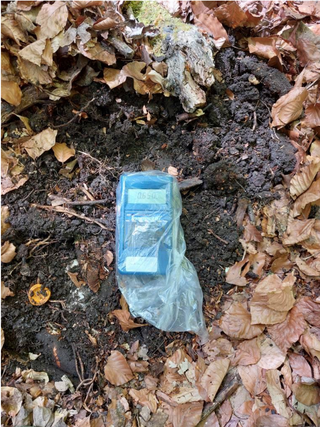
Abb. 11: Messung am Boden mit dem Inspector
