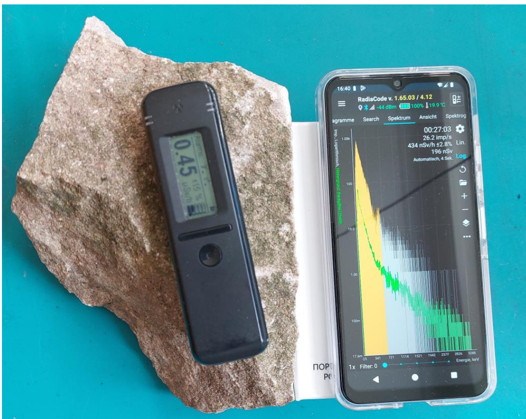
Abb. 20: Messung des gespaltenen Fleinsbrockens mit dem RC-101 zu Hause ( 0.434\mu\text{Sv/h} , 27min Mittelungszeit im Spectrum Mode, Background 0.13\mu\text{Sv/h} )
