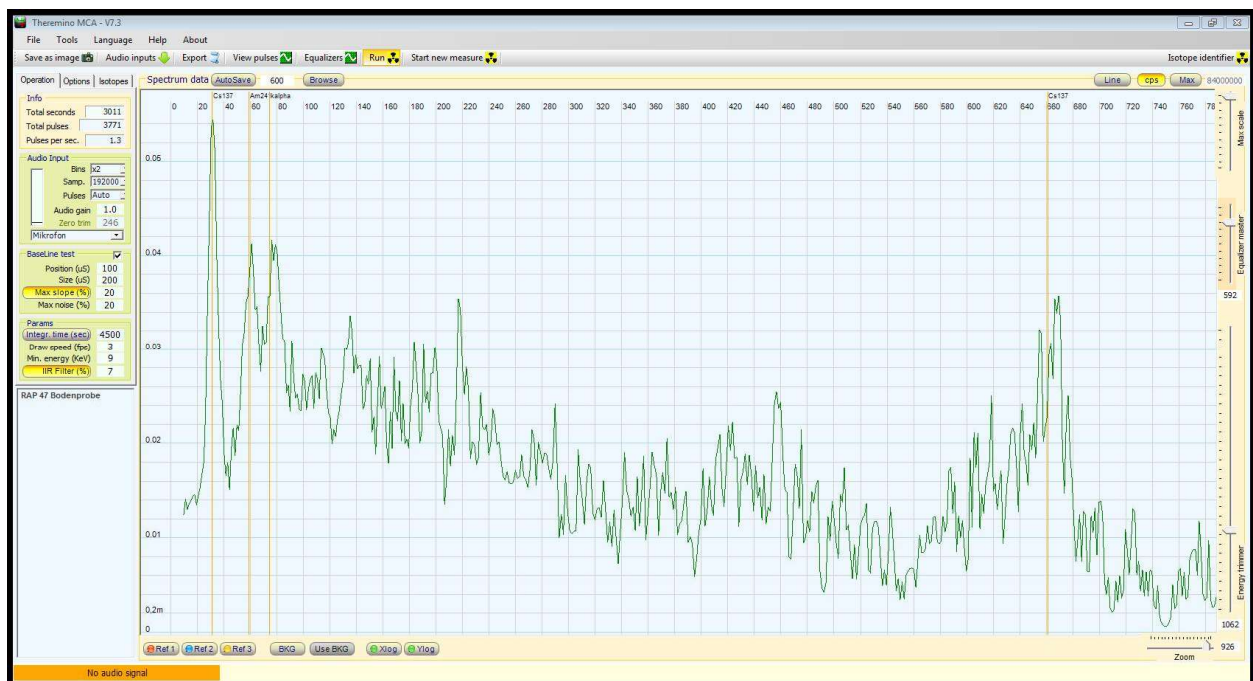
RAP47 low-energy Sonde CsI (TI), 1mm dicke Szintillatorkristall-Scheibe, Karlsruher Referenz-Cäsium
