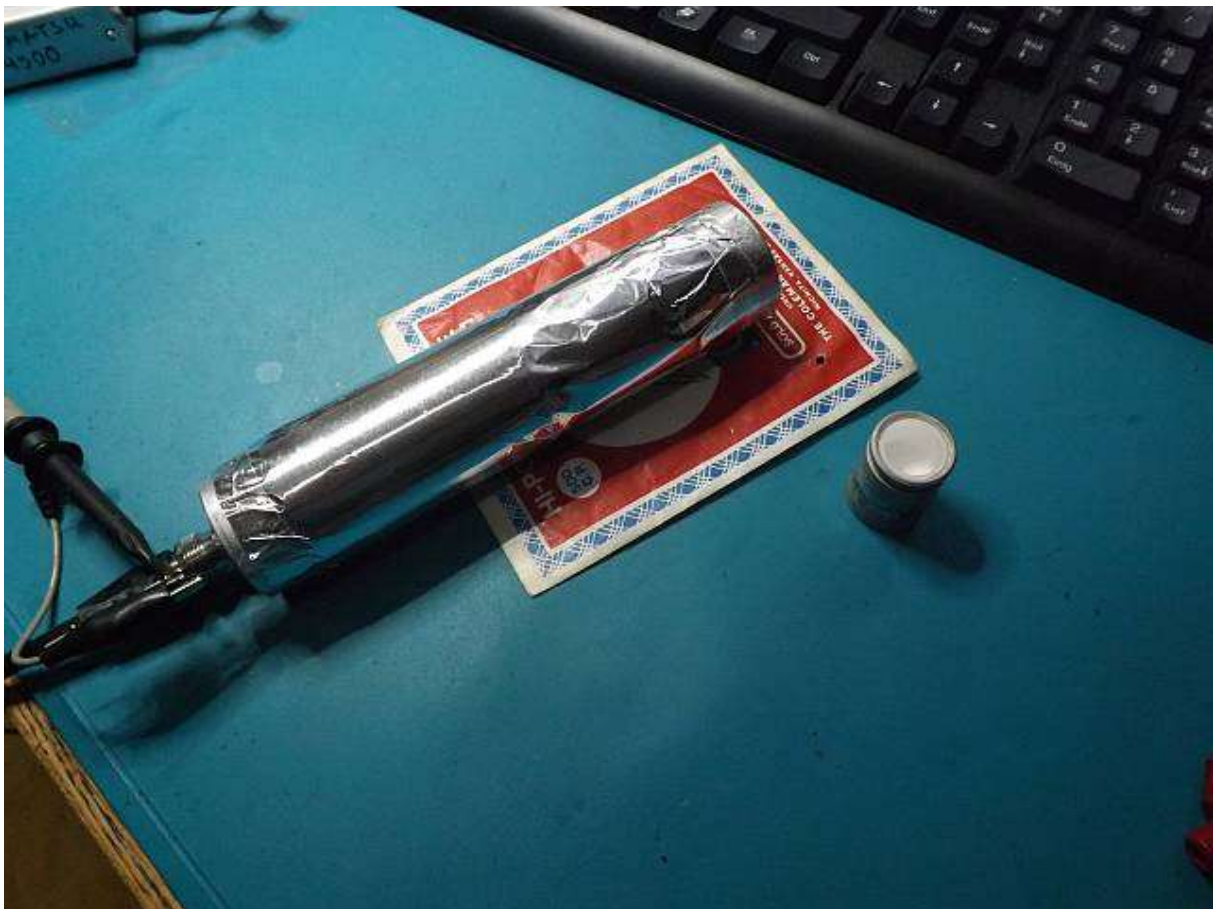
Abb. 2: PMT mit bereits aufgesetztem und licht-geschirmtm BGO-Kristall, daneben der etwas bessere 1cm NaI-Kristall
