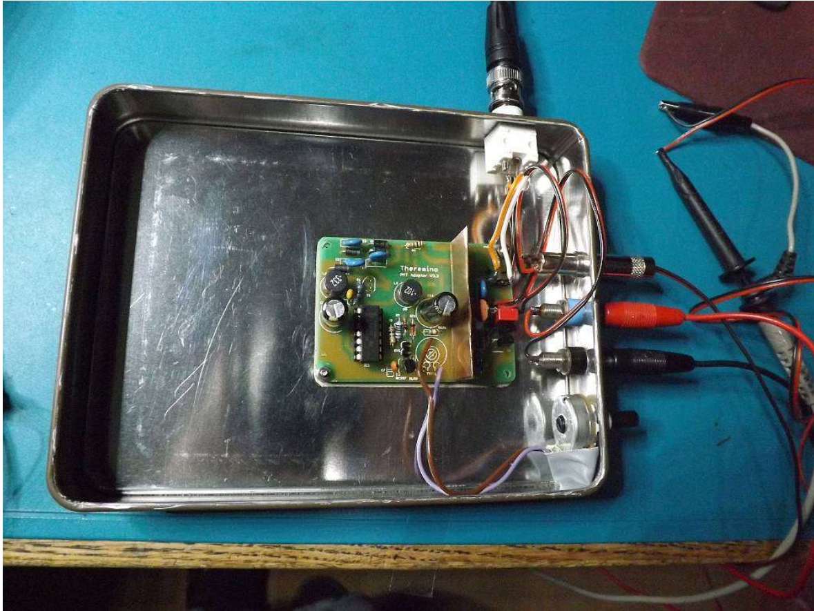
Abb. 4: Thermino PMT-Adapter mit Hochspannungserzeugung und Impulsformung
