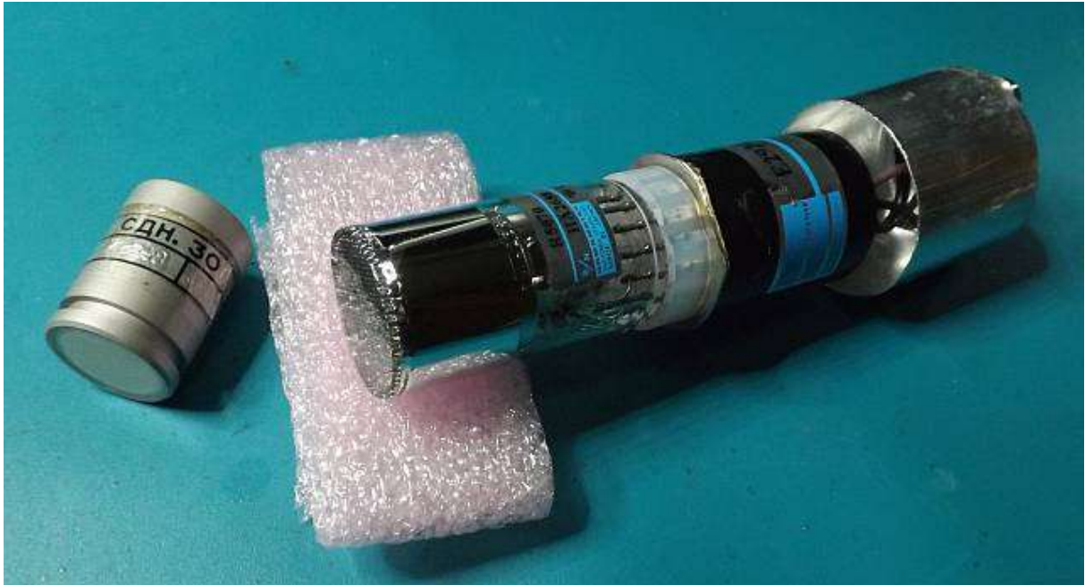
Abb. 1: 1 Zoll PMT R5070 von Hamamatsu mit 1cm NaI Kristall
