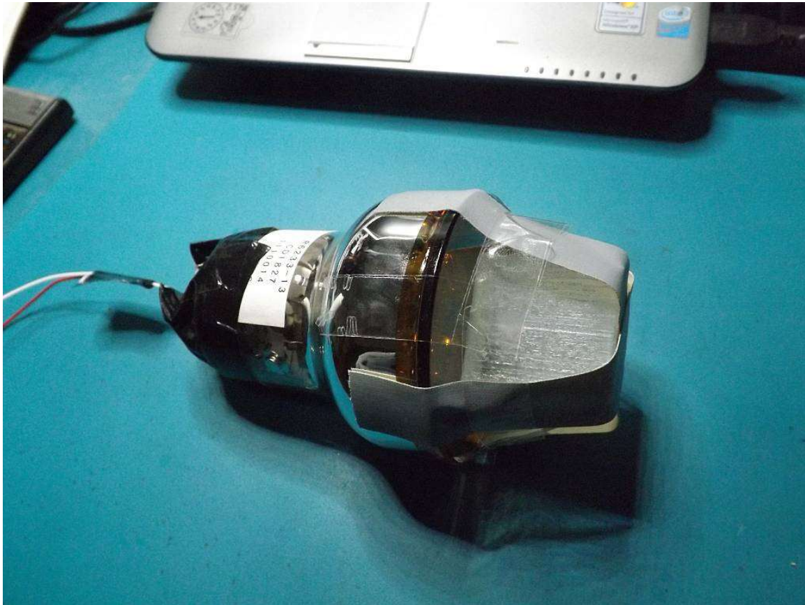
Abb. 5: Provisorische Befestigung eines Plastik-Szintillators auf dem 3 Zoll PMT
