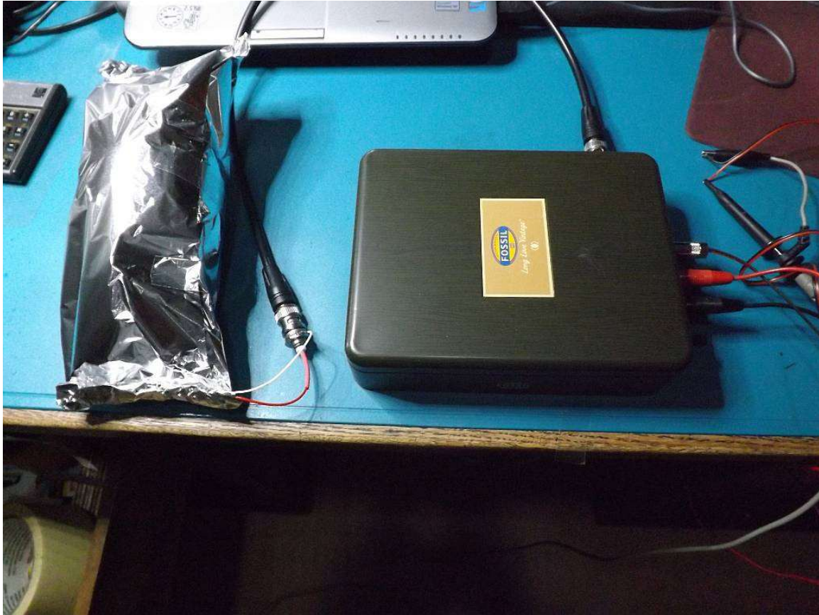
Abb. 6: PMT Adapter in der Blechschachtel mit lichtdicht verpackten 3-Zoll PMT mit Szintillator-Kristall
