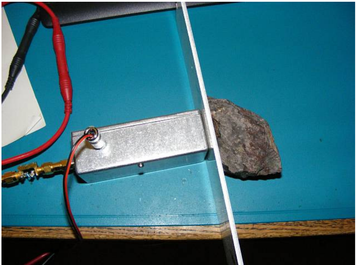
Messanordnung: Mini-Geigerle vor der Pechblende, dazwischen eine 3mm Aluplatte
